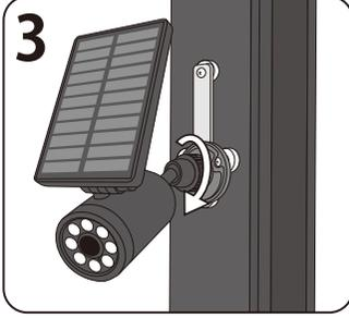
3 本体の角度調整をしながら締め込みリングを時計回りに締めて固定します。
