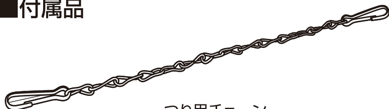
つり用チェーン 本体のつり金具に取付けて下さい。
