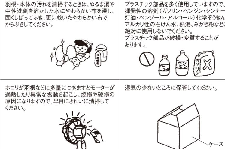
ホコリが羽根などに多量につきまるとモーターが過熱したり異常な振動を起こし、焼損や破損の原因になりますので、早目にきれいに清掃してください。
